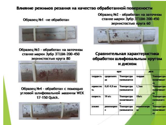
Рис.1 Стенд «Влияние режимов резания на качество обработанной поверхности»
